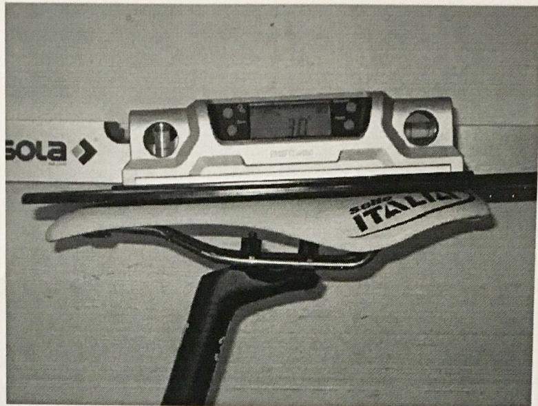
Вимір різниці між висотами найвищої точки передньої та задньої панелей сидіння з допомогою спиртового рівня (допустима межа висот – 1 см)
